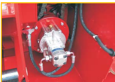
ein zusätzliches Pumpengetriebe sorgt für eine optimale Drehzahl
