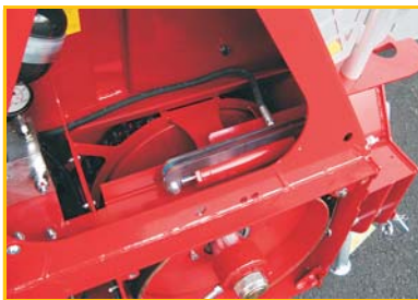
stufenlos regulierbarer Brems- zylinder gewährleistet eine optimale Bremswirkung
