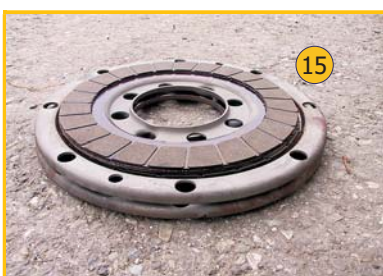
Lamellenkupplung mit 3 bzw. 5 Reibbelägen
