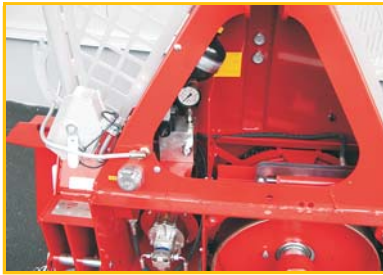
eigener Ölhaushalt mit Pumpe Steuerblock, Druckspeicher und Öltank
