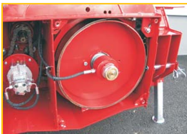
ein wuchtiger Kupplungszyylinder sorgt für den nötigen Trommel- anpressdruck auf die Kupplung
