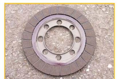
der Kupplungsbelag ist mit einem Spezialkleber aufgeklebt
