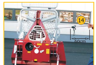
geringer Zugweg der Kupplungsleine erforderlich - auch vom Schlepper leicht zu bedienen!!
