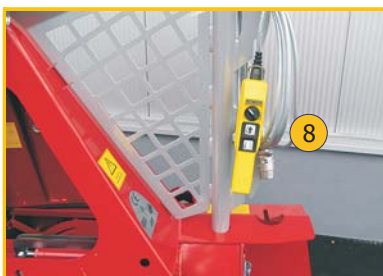
die Steuerung erfolgt entweder über die Kabelbedienung oder über eine Funkfernsteuerung
